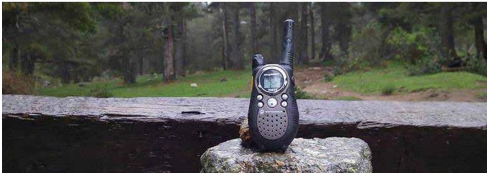
Existen ocho canales de PMR446 separados por 12,5kHz de uno a otro. La regulación de esta banda permite una emisión máxima de 500mW de potencia.
