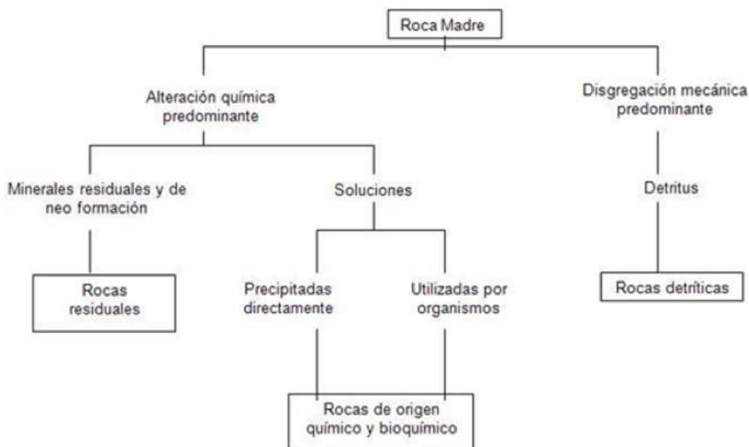
Figura 2. Procesos de formación para las rocas sedimentarias. (Extraído de Tarbut Edward y Lutgens Frederick 2005).
