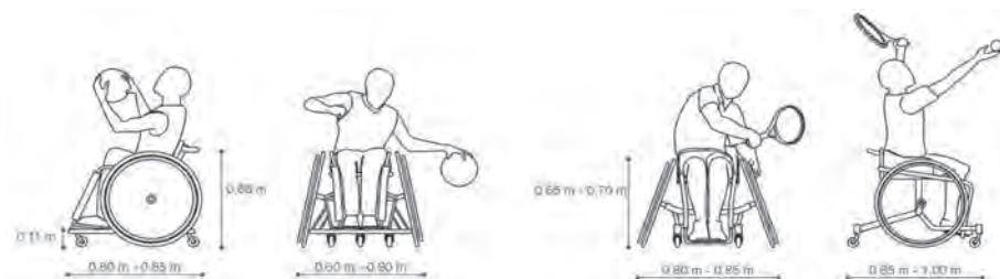
Dimensiones de una silla de ruedas para la práctica de baloncesto (izquierda) y tenis (derecha).
